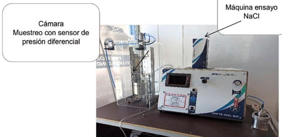
Estación de verificación de mascarillas modelo SAFTE NaCl 0.2.
